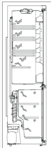
В обычных холодильниках влажность, попадающая в холодильник через дверцу и от продуктов, вызывает обмерзание морозильной камеры. Чтобы разморозить снег и лед в морозильной камере, следует отключить холодильник, достать продукты, которые необходимо хранить при постоянной температуре из него и удалить лед, периодически накапливающийся в морозильной камере.
